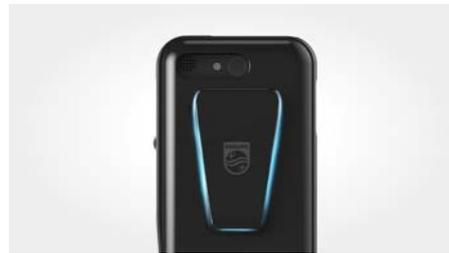
Mit dem Clip an der Hülle kann das Gerät an ein Hemd oder einen Gürtel geklemmt werden. Dadurch ist das Diktiergerät immer in Reichweite.
