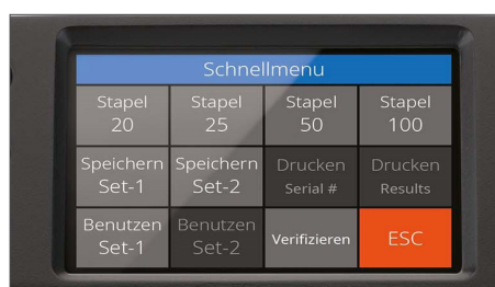
Hochauflösendem Touchscreen mit mehrsprachiger Benutzeroberfläche und Schnellmenü
