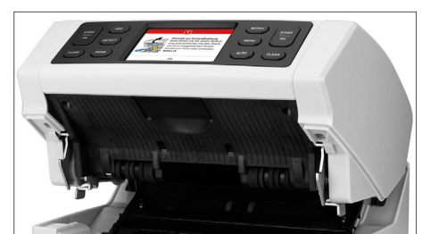
Innenteile können durch Öffnen der Oberseite leicht gereinigt werden
